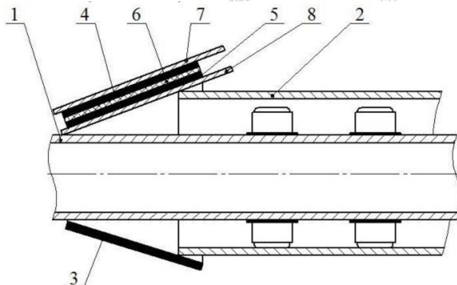
1 – стальной футляр; 2 – трубопровод; 3 – манжета; 4 – укрытие манжеты; 5 – малый хомут для крепления манжеты; 6 – большой хомут для крепления манжеты; 7 – болтовое соединение; 8 – соединение двух полукожухов укрытий;
