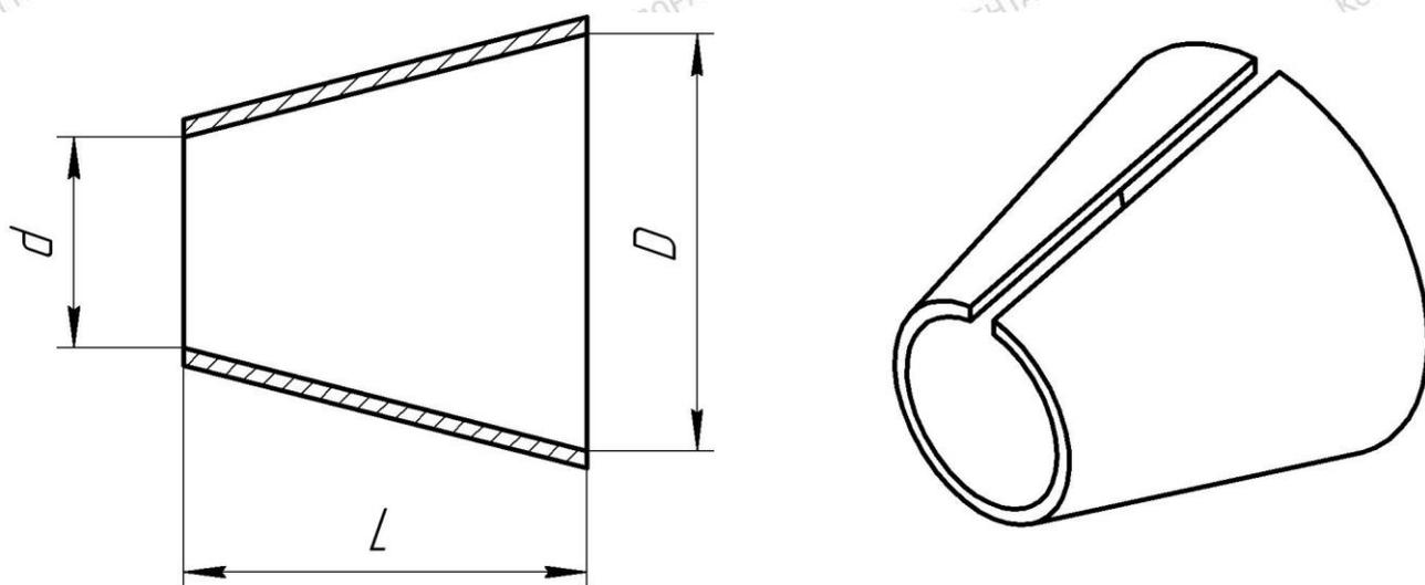
Рисунок 2 - Общий вид МГП-Анодь разъемной
